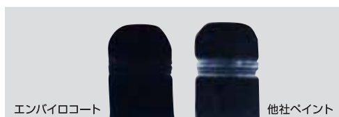
スクラブテスト 専用の機器を使いワイヤーブラシ で200回往復する摩耗テスト
